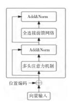
图 4 Transformer 中编码器结构
