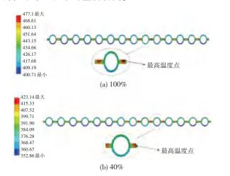
图 3 BMCR 和 40%BMCR 工况下管屏截面温度分布情况
