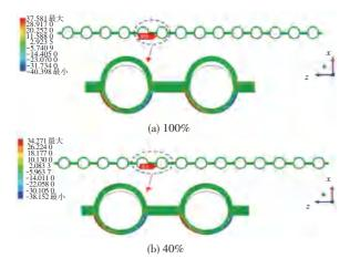
图 5 BMCR 和 40%BMCR 工况下管屏 YZ 方向最大剪切应力分布 情况
