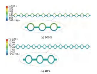
图 4 BMCR 和 40%BMCR 工况下管屏截面热应力分布情况
