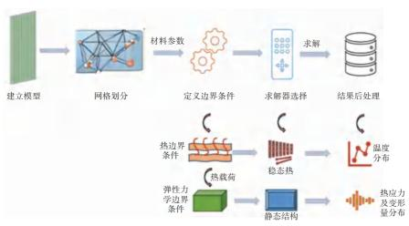
图 1 热-应力分析的一般过程
